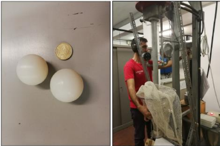
Figura 52. Inserimento delle stere di poliammide all'imbocco della canna di sparo
