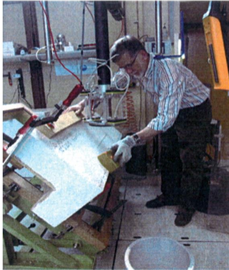
Figura 2: Bombardamento degli spigoli del provino angolo; preparazione della superficie
