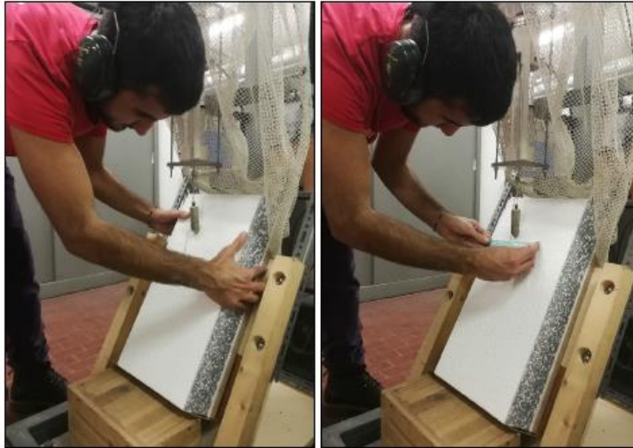
Figura 51. Posizionamento del provino sul supporto utilizzando il filo a piombo per determinare la zona di impatto
