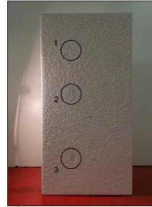
Foto del provino con luce radente dopo la prova di resistenza all'impatto
