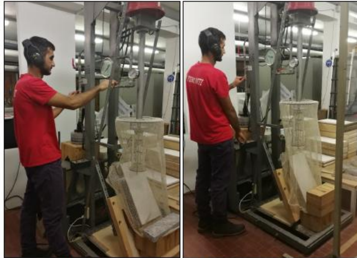
Figura 53. Regolazione della pressione, tramite le valvole, fino ad eseguire il tiro alla velocità voluta
