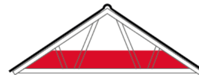
Isolamento dell'ultimo solaio
