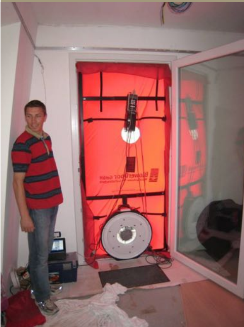
Prova della tenuta all'aria "Blower Door Test"
